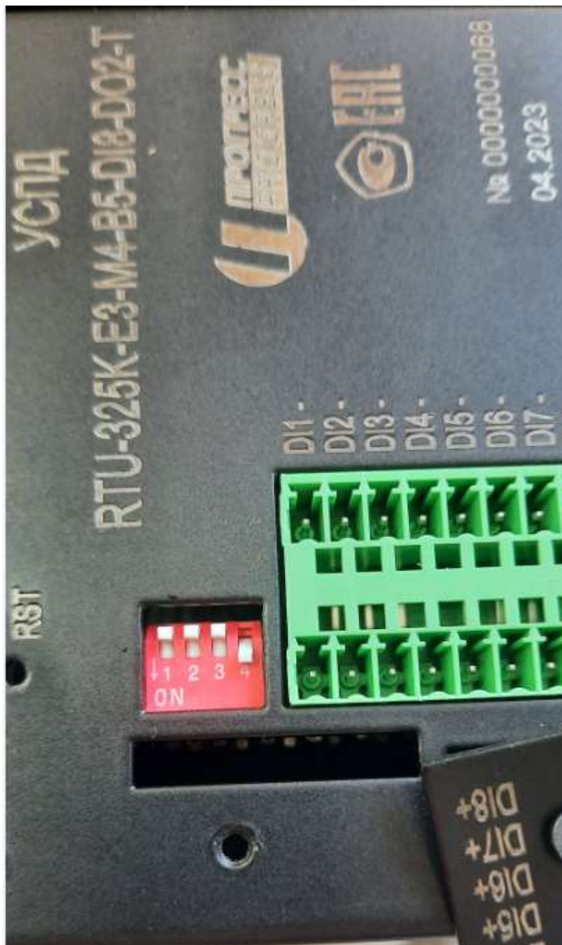
Рис.1.10. Под крышкой S1 расположены 4 переключателя.
