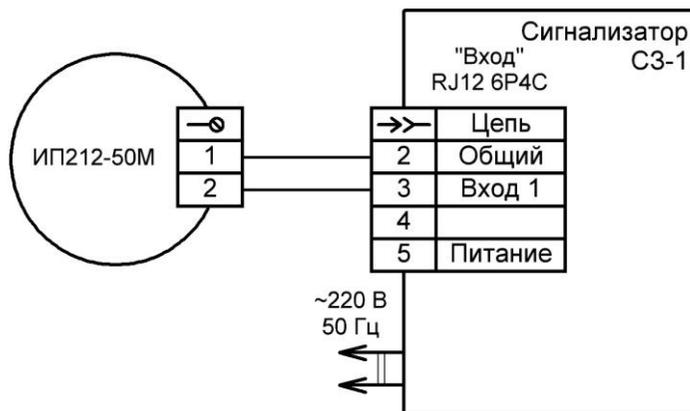
Рис.2 Схема подключения пожарного извещателя ИП 212-50М
