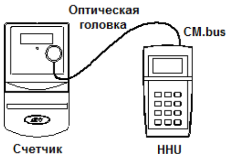
Рис. 4. Подключение модуля HNU к счётчику.
